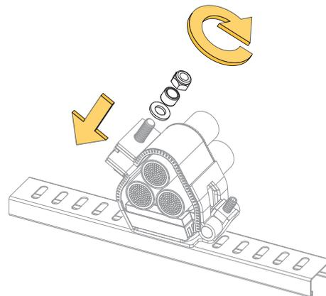
7. СЛЕГКА ЗАТЯНУТЬ ГАЙКУ КРЕПЕЖНОГО БОЛТА
