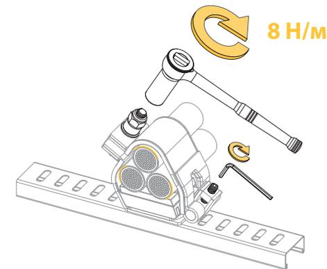
8a. ЗАТЯНУТЬ РЕГУЛИРУЮЩИЙ БОЛТ ТАК, ЧТОБЫ ВСЕ КАБЕЛИ БЫЛИ ЗАФИКСИРОВАНЫ
