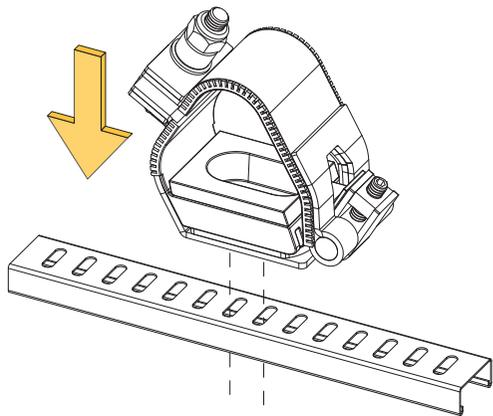
1. РАЗМЕСТИТЬ КАБЕЛЬНУЮ СКОБУ НА ОПОРНОЙ ПОВЕРХНОСТИ
